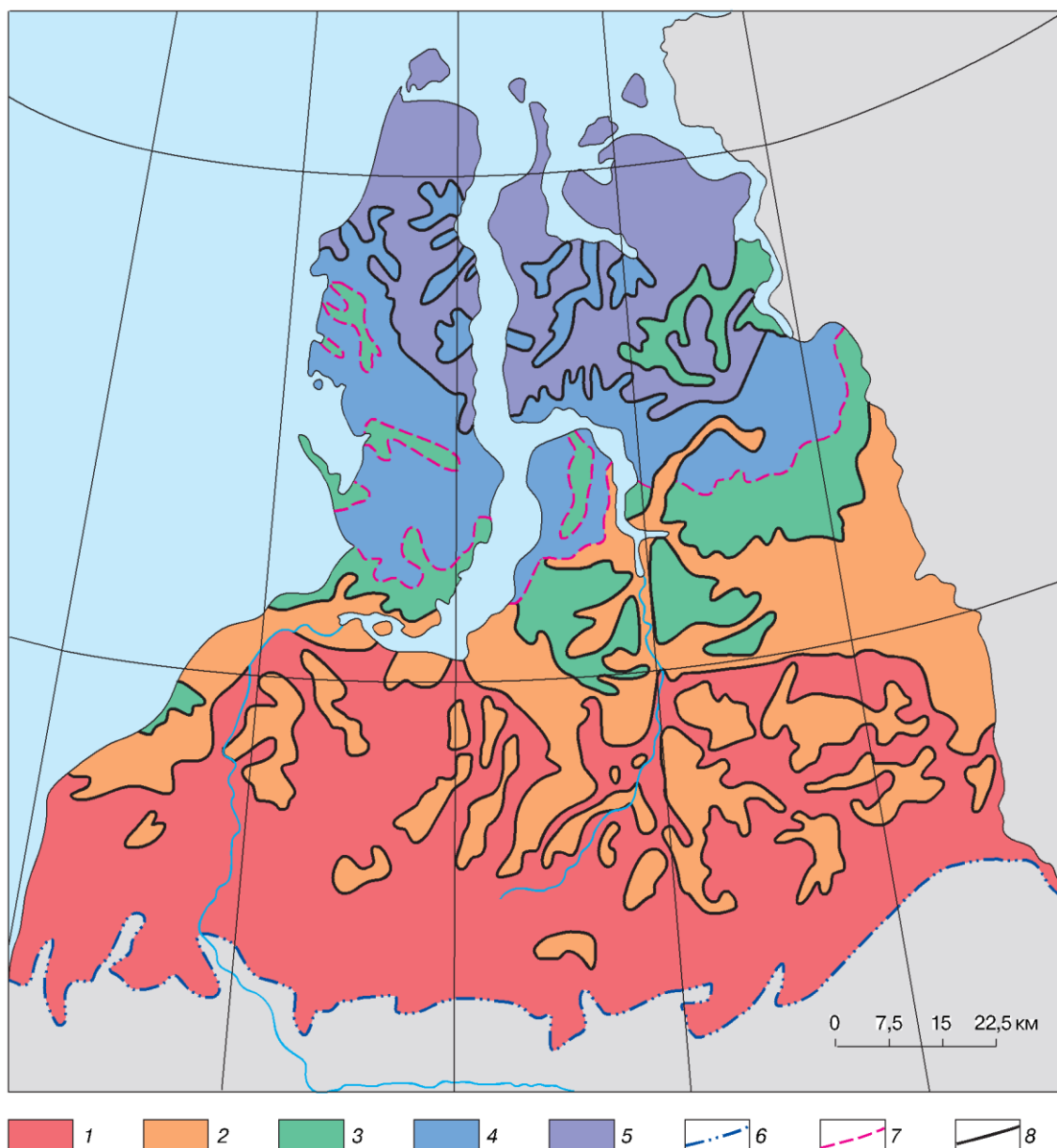
Рис. 4. Прогнозная геокриологическая карта севера Западной Сибири на 110-й год от начала возможного глобального потепления климата (по сценарию ИГКЭ): 1 – территория протаявших ММП; 2 – территория распространения ММП несливающегося типа с глубиной залегания кровли ( h ) в торфах более 3,5 м, в суглинках 8–15 м, в песках 15–25 м и где среднегодовая температура пород ( t_0 ) повысится от 0 \pm -3 до 0 \pm -0,5 °С; 3 – территории распространения ММП несливающегося типа с h в торфах 1,5–3,5 м, в суглинках 3,5–8 м, в песках 6–13 м и где t_0 повысится от -3 \pm -5 до -1 \pm -2 °С; 4 – территории распространения ММП, t_0 которых повысится от -5 \pm -7 до -1 \pm -2 °С с участками несливающихся ММП, где h в торфах до 1,5 м, в суглинках до 3,5 м, в песках до 6 м; 5 – территории сплошного распространения ММП, t_0 которых повысится от -7 \pm -9 до -2 \pm -4 °С; границы: 6 – современная южная граница распространения ММП, 7 – прогнозная южная граница распространения ММП, 8 – граница территорий с разными прогнозными геокриологическими условиями
